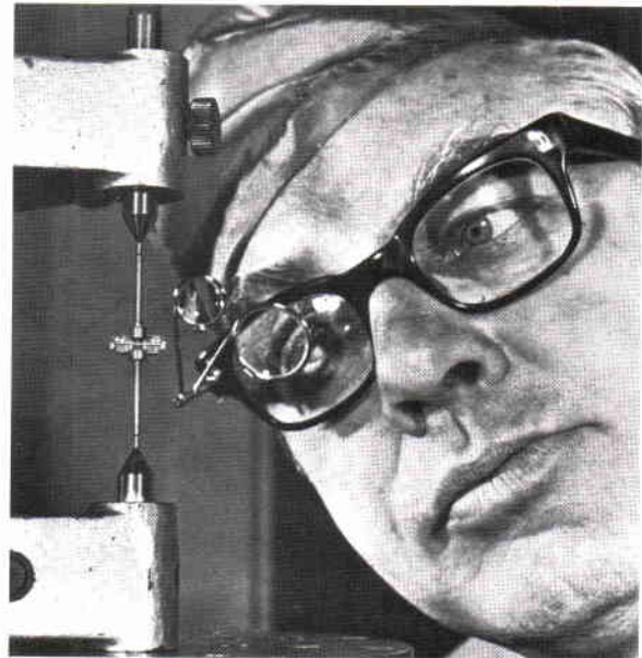
Honeywell vibrationsrategyro utan roterande delar mäter vinkelhastigheter mellan 0,02—6500 grader per sekund och har en medeltid mellan fel på 75 000 timmar.
