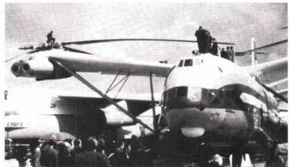
Världens största helikopter. Ryska giganten MIL Mi 12 har 73 meters spännvidd och 33 meters längd. Rotorblad och motorgondoler används som arbetsplattformar. Observera mannen på rotorväxeln.
